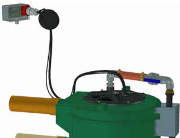
5. Tarkista, että pumpun lähtevänputken ja tonttihaaran sulku venttiilit ovat auki. Työnnä pumppaamon pistoke ohjauskeskukseen. Kiinnitä paineentasaaja sähkökaapeliin.
