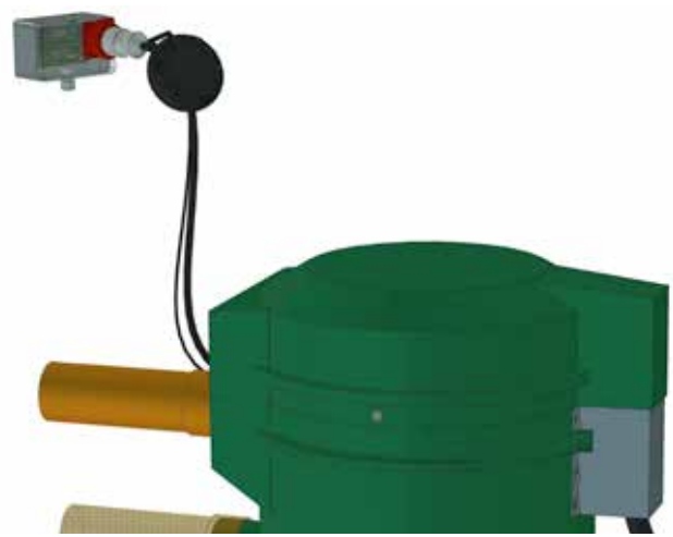
6. Koekäytä ja testaa hälyttimen toiminta seuraavan sivun tarkistuslistan mukaisesti. Sulje kansi ja lukitse se mukana tulevilla lukituspulteilla.
