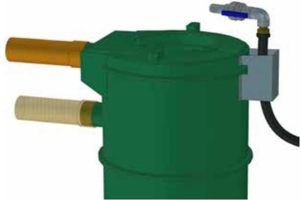
2. Asenna ulosmenoventtiili lähtevään paineputkeen. Venttiin keskikohdan tulee olla n. 14 -15 cm pumpun yläpuolella.
