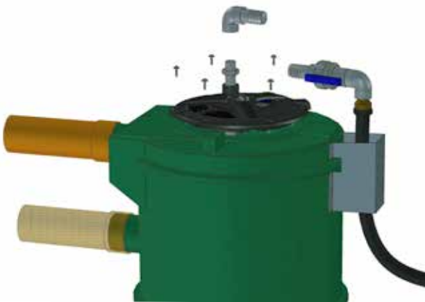
3. Aseta pumpu paikoilleen. Huomaa, että pumpu tulee asettaa siten, että ulosmenoputki on kello 2:een, jos sisääntuloputki on kello 12:sta.
